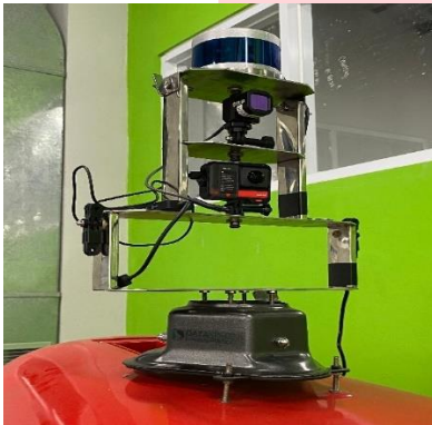
GAMBAR 5 Instalasi Thermal Camera FLIR Pada Mobil KLO
