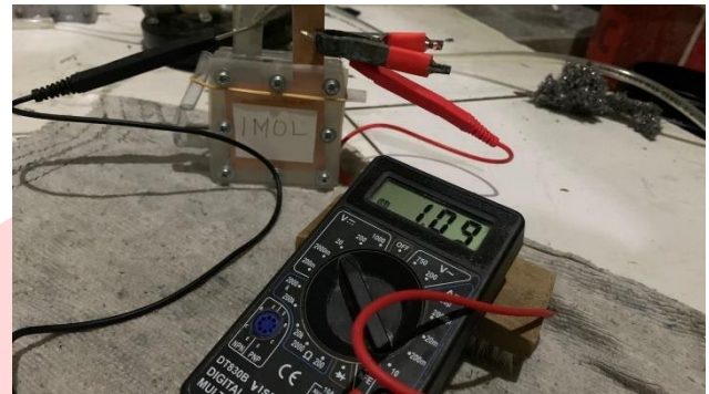
GAMBAR 15 Hasil Keluaran Baterai dengan Konsentrasi 1
