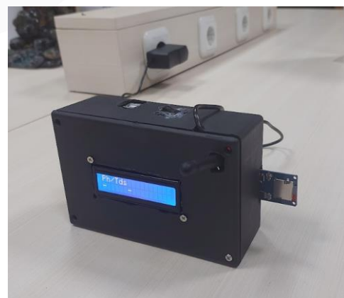
GAMBAR 12. Bentuk fisik receiver beserta sistem penyimpanan data
