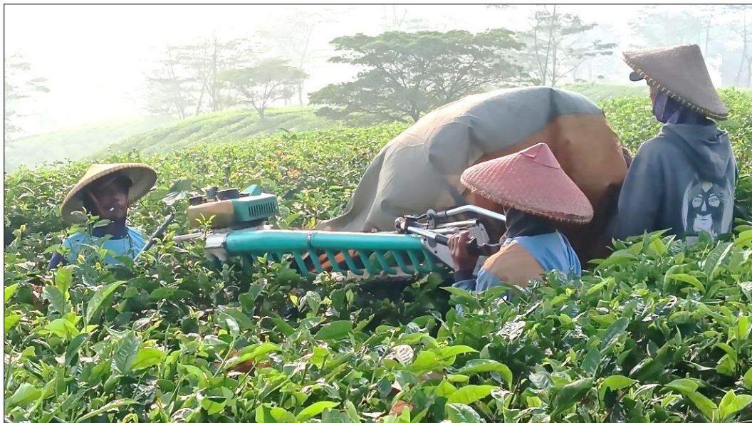
Gambar I. 2 Alat Pemetik Pucuk Daun Teh Eksisting
