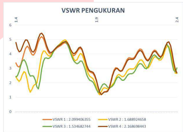
GAMBAR 4.2 Nilai VSWR Hasil Pengukuran
