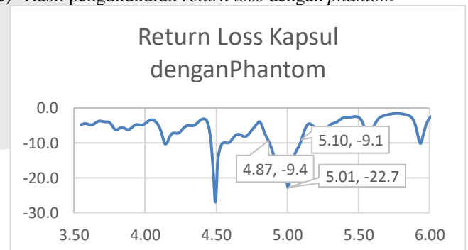
Gambar 24 Hasil Pengukuran Return Loss dengan Phantom
