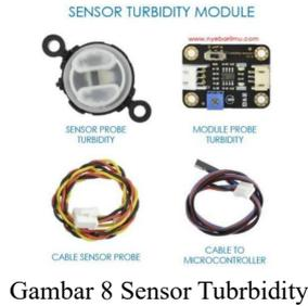
Spesifikasi untuk sensor turbidity adalah memiliki tegangan operasional sebesar 5VDC, respon kurang dari 500mS, dapat bertahan dengan rentang suhu 5°C hingga 90°C dengan *output* analog sebesar 0V hingga 4,5V. *Output* yang ideal untuk kalibrasi adalah tegangan setelah uji coba sebesar 4,2V.
