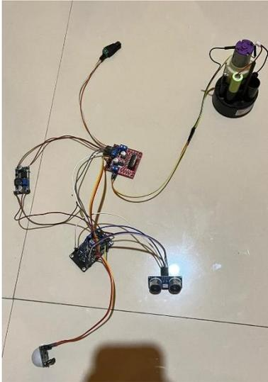
Ini adalah hasil dari perencanaan skema rangkaian yang telah dijelaskan dalam bab sebelumnya. Gambar ini menggambarkan cara komponen-komponen seperti Nodemcu, sensor ultrasonik, sensor PIR, Motor Driver L289N, step-down, dan penggunaan aplikasi Blynk terhubung dalam perancangan Alat Cuci Tangan Otomatis Berbasis IoT sebagai Langkah Efisiensi Sabun di Kampus A. Gambar ini memberikan gambaran visual tentang bagaimana perangkat ini akan diimplementasikan.
