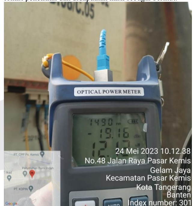
Gambar 15. Hasil pengukuran Redaman pada ODP Gelam
