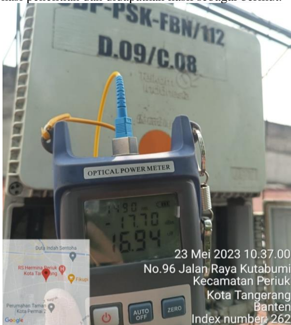
Gambar 14. Hasil pengukuran redaman pada ODP Nagrak
