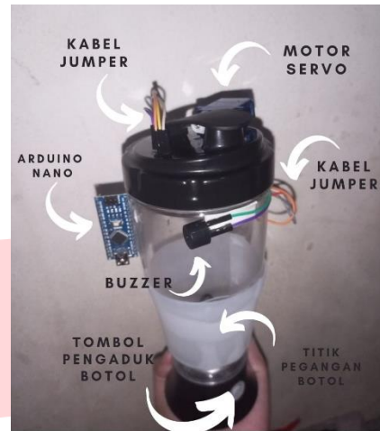
Gambar 1 (Realisasi Tampilan Alat)
