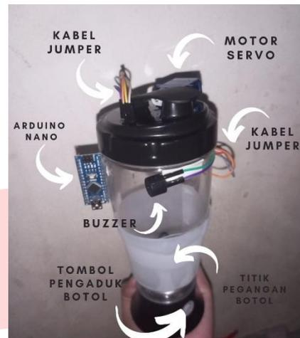
Arduino Nano dan *buzzer* sebagai kontrol utama buka tutup tempat minuman. Untuk *buzzer* sendiri dilakukan pengujian apakah dapat menghasilkan suara ketika sensor ultrasonik HC-SR04 menginisiasi jarak air yang terisi di tempat minum sesuai jarak yang sudah diprogram sebelumnya. Pengujian yang dilakukan secara keseluruhan antara lain:
