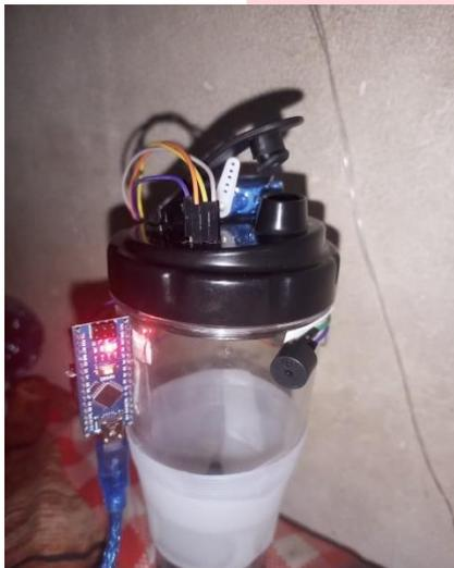
Pada Gambar 7 terlihat bahwa ketika sensor ultrasonik menginisiasi bahwa botol kosong atau akan diisi maka *motor servo* menggerakkan tutup botol untuk terbuka agar penyandang tunanetra langsung bisa mengisi air tanpa harus meraba-raba terlebih dahulu untuk membuka tutup botolnya. Lalu pada saat botol sudah terbuka maka *buzzer* dalam keadaan bunyi sebagai penanda bahwa penyandang tunanetra bisa langsung mengisi air ke dalam botol tersebut.
