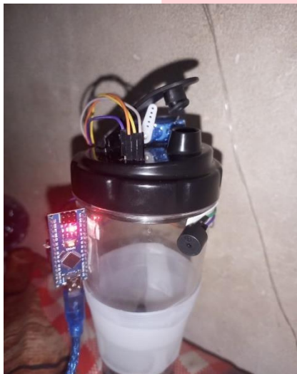
Gambar 7 (Realisasi Perangkat Motor Servo dan Buzzer Saat Terindikasi Botolnya Kosong/Sedang Diisi)
