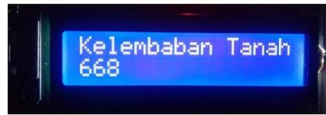
Gambar 4. 26. Hasil data realtime kelembaban tanah pada LCD
