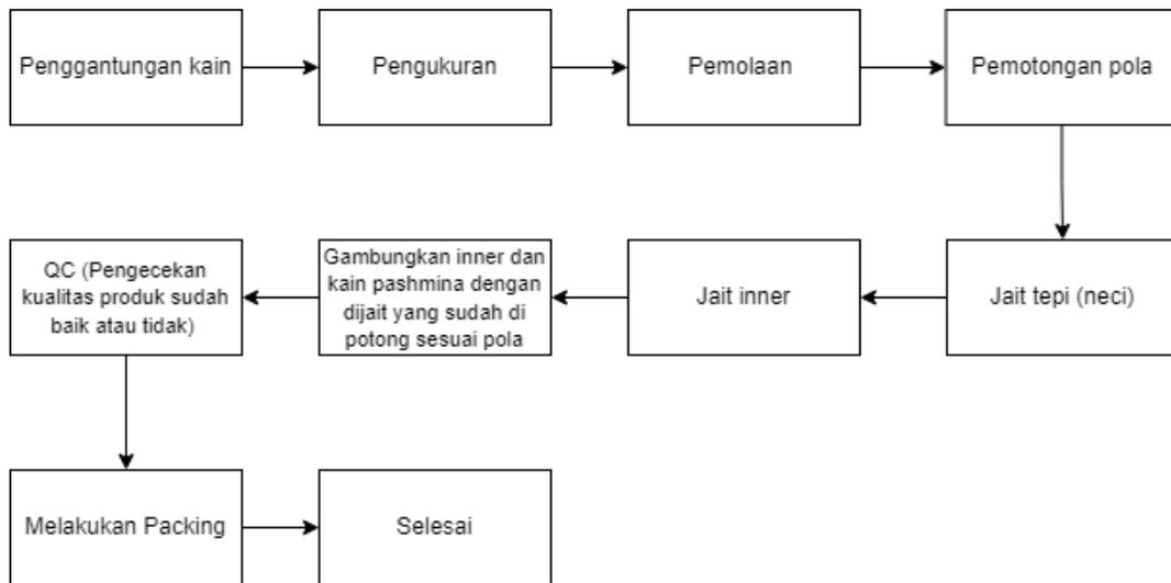
Gambar I. 4 Tahapan proses produksi Pashmina Inner
