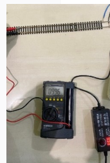
GAMBAR 7 (PENGUJIAN TEGANGAN PADA REL)
