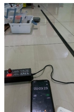
GAMBAR 8 (PENGUJIAN KECEPATAN LINIER MENGGUNAKAN 4,04V)
