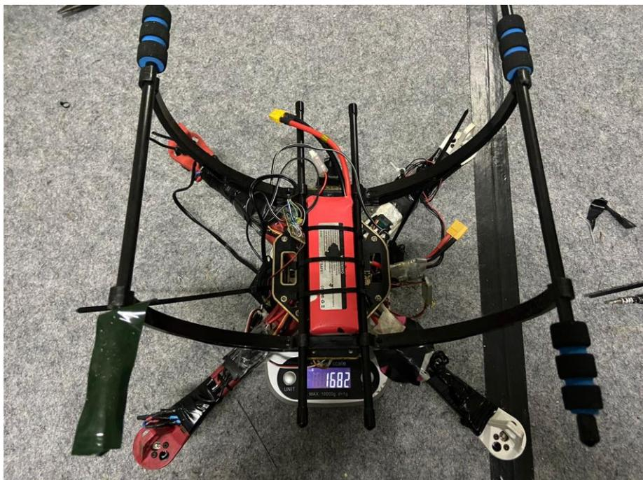
Gambar 4.5 Pengukuran Berat Drone
