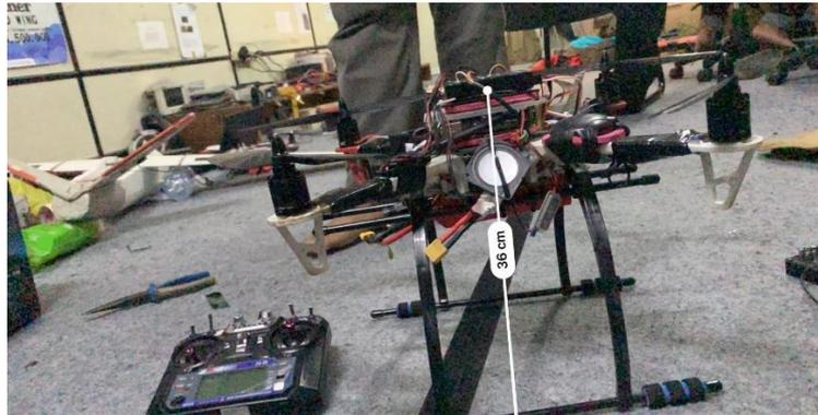
Gambar 4.4 Pengukuran Tinggi Drone
