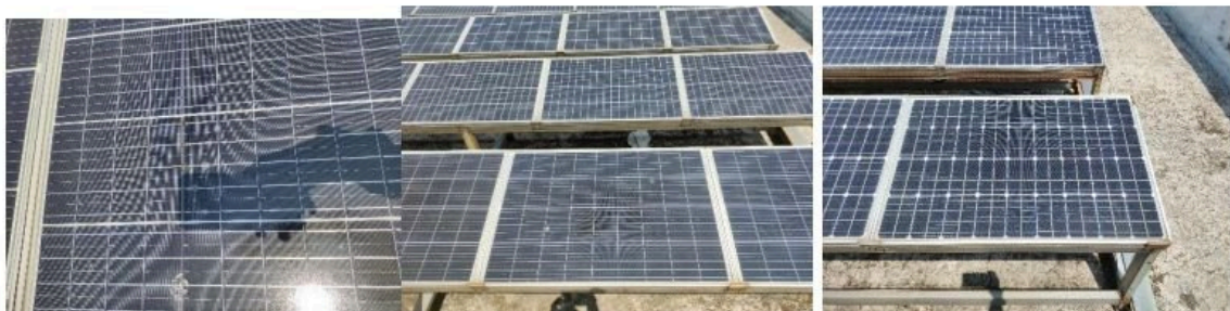
Gambar 1.1 Gambar panel surya yang memiliki hot spot yang dapat dilihat oleh mata telanjang
