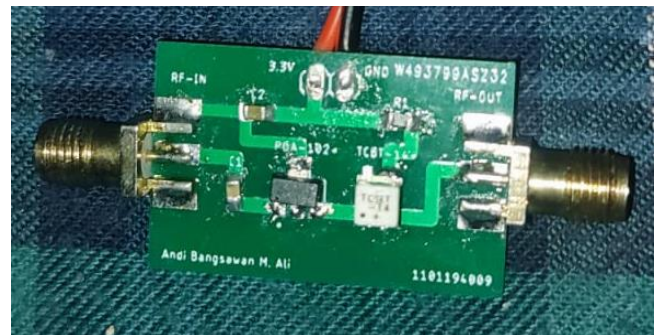
GAMBAR 4.1 (Hasil Fabrikasi LNA)
