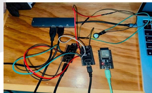
GAMBAR 5 Penyambungan Sensor Pulse Ke ESP 32
