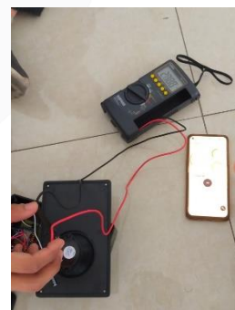
GAMBAR 4 Pengukuran Frekuensi Output dengan Multimeter
