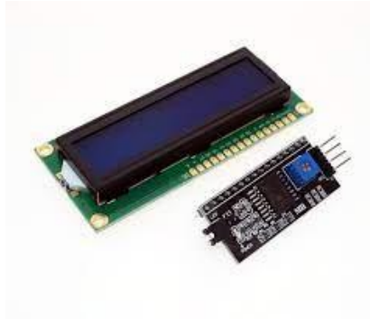
GAMBAR 2.6 LCD 12C 16x2
