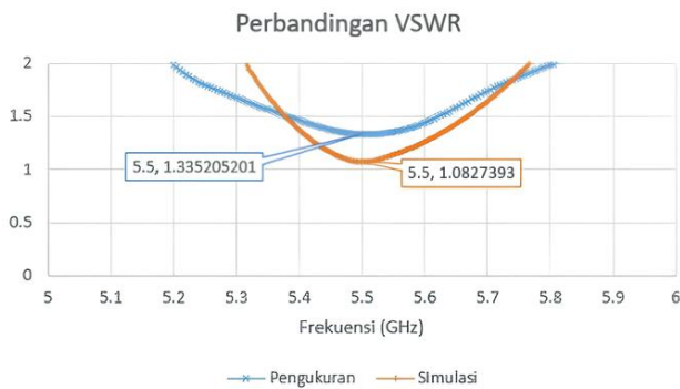
GAMBAR 10 (Perbandingan nilai VSWR kondisi breastphantom dengan kanker)
