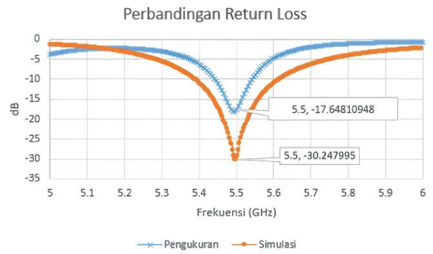
Gambar 7 (perbandingan nilai return loss kondisi breast phantom tanpa kanker)
