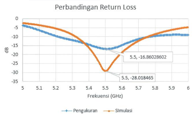
GAMBAR 9 (Perbandingan return loss kondisi breastphantom dengan kanker)
