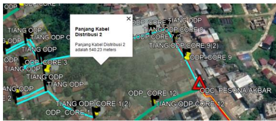
GAMBAR 5. Panjang Kabel Distribusi 2
