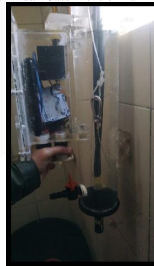
GAMBAR 5 Pengujian Botol Niskin & Case Elektronika
