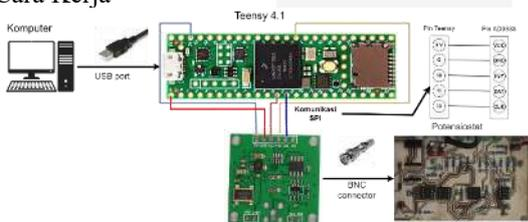
GAMBAR 1 Skematik sistem kerja alat pada *Function Generator*
