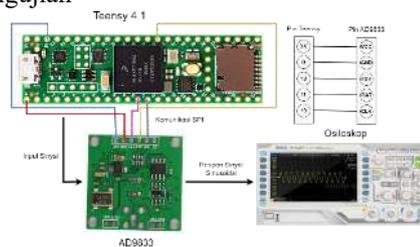
GAMBAR 3 Kalibrasi komponen pada *Function Generator* AD9833
