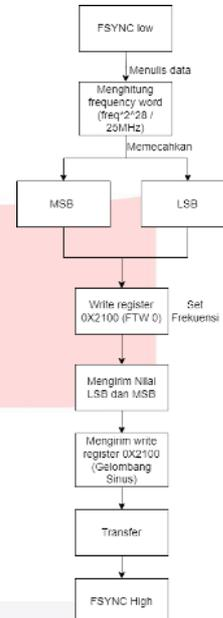
GAMBAR 2 Flowchart Register pada AD9833
