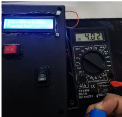
GAMBAR 3.4 Perbandingan Sensor dengan Multimeter.
