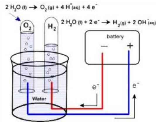
**Gambar 1. 1 Proses Elektrolisis**
