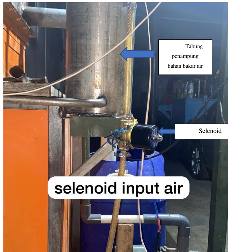
Gambar 1. 4 Sistem pengisian tabung bahan bakar air otomatis menggunakan sistem monitoring yang terintegrasi dengan solenoid yang memompa air ke tabung penampung
