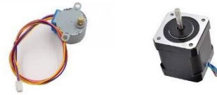
GAMBAR 19 Motor stepper 28BYJ (kiri) dan Motor stepper Nema 17 (kanan)
