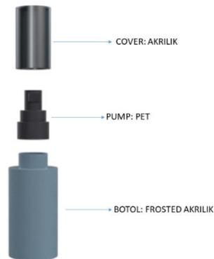
Gambar 9 Exploded View dan Skema Material Botol Serum
