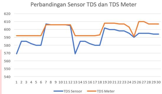
GAMBAR 6 Perbandingan Pembacaan Sensor SEN0224 dengan TDS Meter
