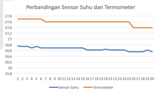
GAMBAR 8 Perbandingan Pembacaan Sensor DS18B20 dengan Termometer
