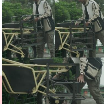
Gambar 8 Operasional Keranjang Lipat
