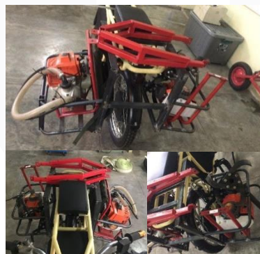
Gambar 11 Uji Coba Sepeda Motor Listrik Dengan Membawa Alat Pertanian
