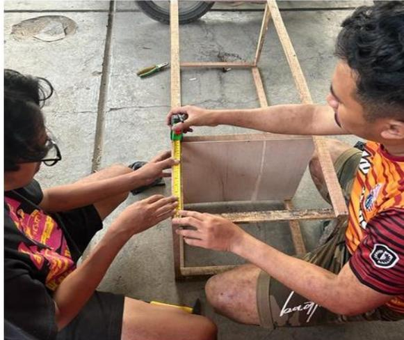
Gambar 21 Proses pembuatan rangka pedestal
