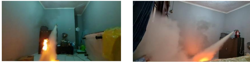
Gambar 3.9 Semprotan Apar saat pengujian
