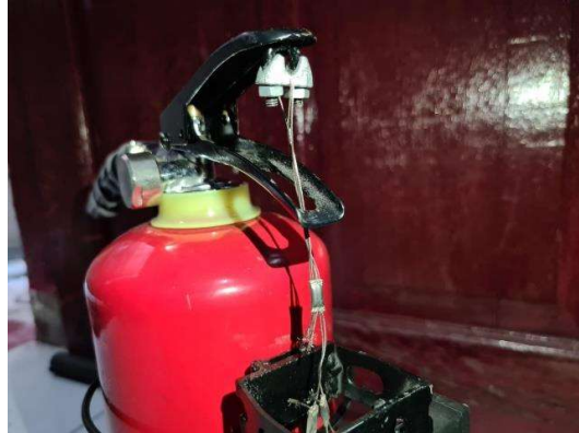
Gambar 4. 1 mekanisme menarik tuas
