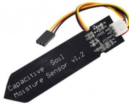
Gambar 6. Sensor Kelembapan
