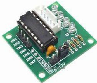
GAMBAR 6 Motor Driver ULN2003
