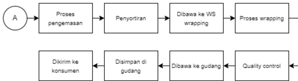
Gambar I.1 Alur Proses Pengemasan Teh Celup PT XYZ (Lanjutan)
