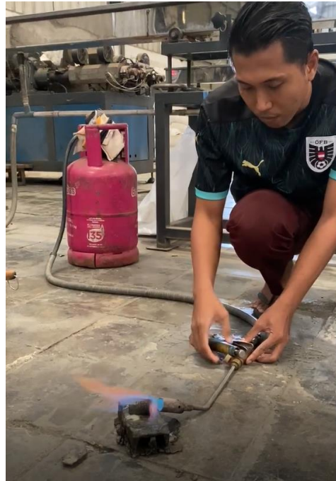
Gambar I. 2 Proses Pembakaran Cetakan Extruder
