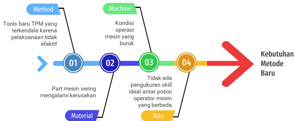
Gambar I.9 Diagram *Fishbone* Penyebab Rusaknya Mesin CM-10
