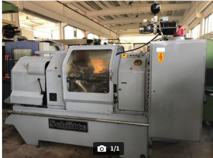
Gambar I.4. *Chucking Machine* (Sumber: Industriale.it)
