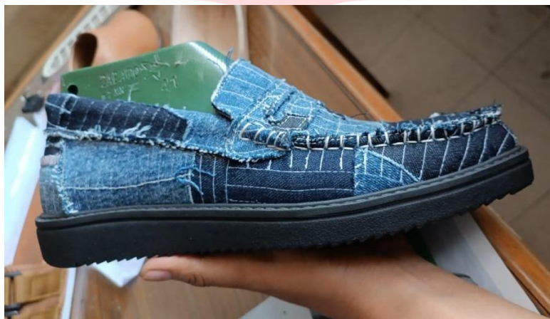
Gambar 4. 11 Hasil proses penggabungan bagian upper dengan sole sepatu (Sumber: Dokumentasi Penulis)
