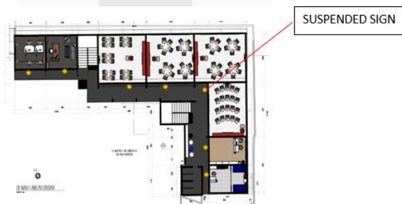
Gambar 8 Peletakan Suspended Sign
