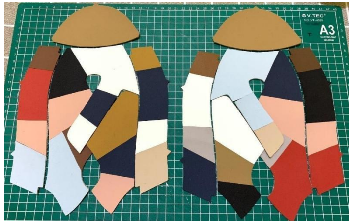
Gambar 7: Peletakkan limbah kulit sesuai dengan pola Sumber: Dokumentasi Penulis, 2022
