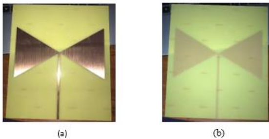
GAMBAR 5 PCB 1 (A) TAMPAK DEPAN (B) TAMPAK BELAKANG.
