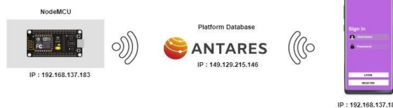
GAMBAR 4.3 PENGUJIAN DARI NODEMCU KE ANTARES
