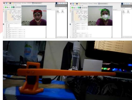
Gambar 7 Pengujian kontrol palang pintu dengan deteksi masker
