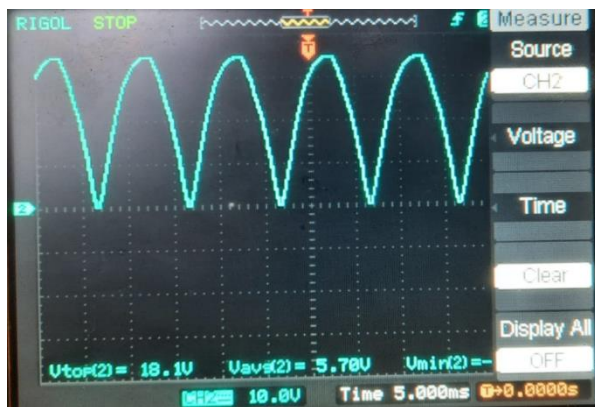
Gambar 11 Grafik Osiloskop dioda 4A (D4SB)
