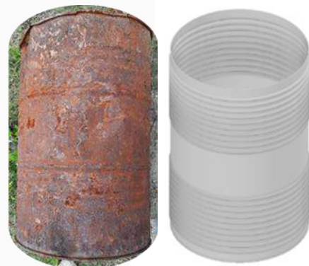
GAMBAR. 3 Gambaran nyata dan geometri pemodelan drum minyak aktual
