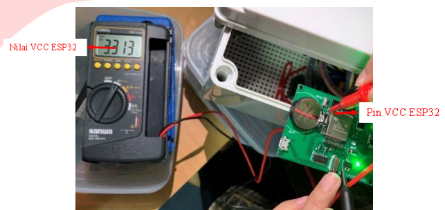
GAMBAR 7 UJI TEGANGAN PADA KOMPONEN ESP32
