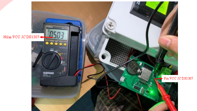
GAMBAR 11 UJI TEGANGAN PADA IC DS1307
