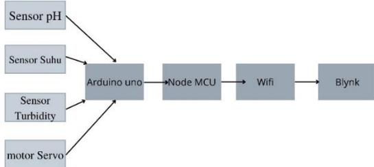
Proses ini menggunakan pemrograman bahasa C menggunakan mikrokontroler Arduino IDE. Mikrokontroler menerima data dari sensor turbidity, sensor Suhu, sensor pH dan motor Servo. Kemudian datanya akan dikirimkan ke Blynk menggunakan NodeMCU.
