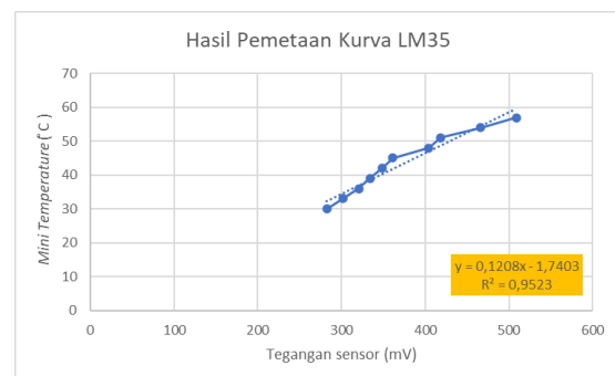
Gambar 6 Hasil Pemetaan Kurva Linier dan Persamaan dari Sensor LM35 (L)
