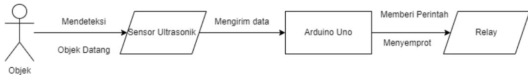
Gambar 18 Skema Penyemprotan Desinfektan
