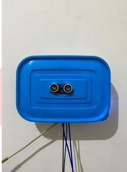
Gambar 16 Sensor Ultrasonik untuk membuka pintu
