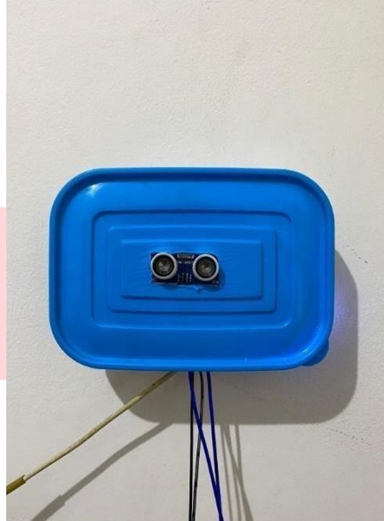
Gambar 16 Sensor Ultrasonik untuk membuka pintu
